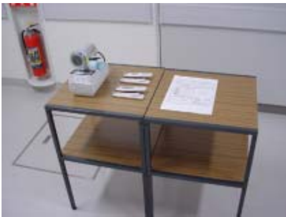
前室1 : 来院時用サ - ベイメ - タと記録用紙、個人被曝管理用ポケット線量計
