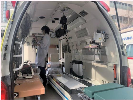
新しいドクターカーは今と同じトヨタの救急車ですが、最新モデルをベースにあちこち改造されています。カーナビやドラレコ、ETCは当たり前。電動カーテンに衛星電話、テレビ（しかも2つ!）、おまけにWi-Fiルーター (!! )と便利でビックリな機能がてんこ盛りです。さらに、車の左側からタープ（屋根）を伸ばせば雨の日の屋外ミーティングも安心です。
